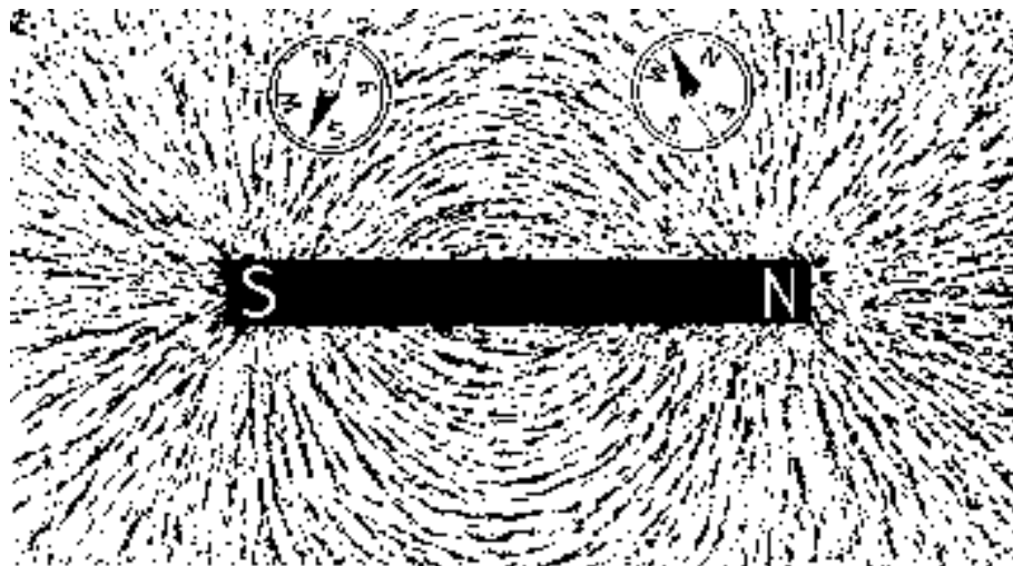
Figura 12.1: Orientación de virutas metálicas por un imán.
